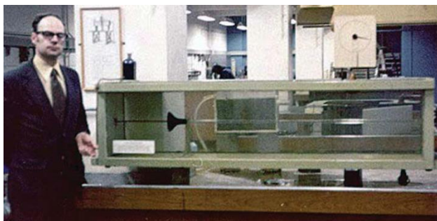
Aparelho original de Osbone Reynolds (Universidade de Manchester) Çengel e Cimbala (2015)
