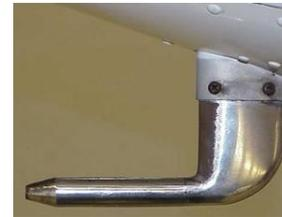
(tubo de Pitot acoplado a uma aeronave para a medida de sua velocidade)
