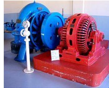
Turbina acoplada ao gerador
